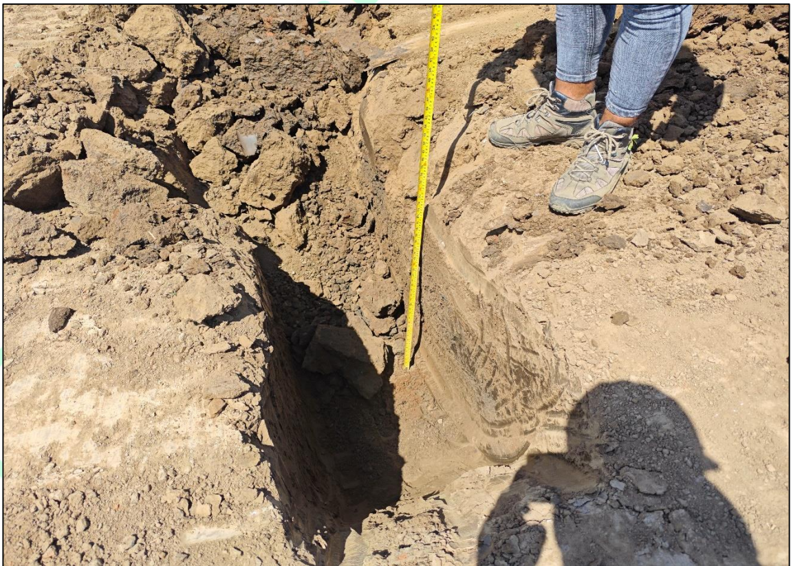
Imagen 9. Apique 1 terminado y medición de perfil estratigráfico.
