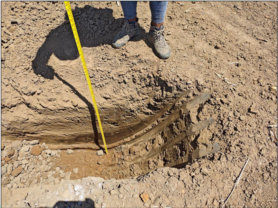
Imagen 20. Apique 12 terminado y medición de perfil estratigráfico.
