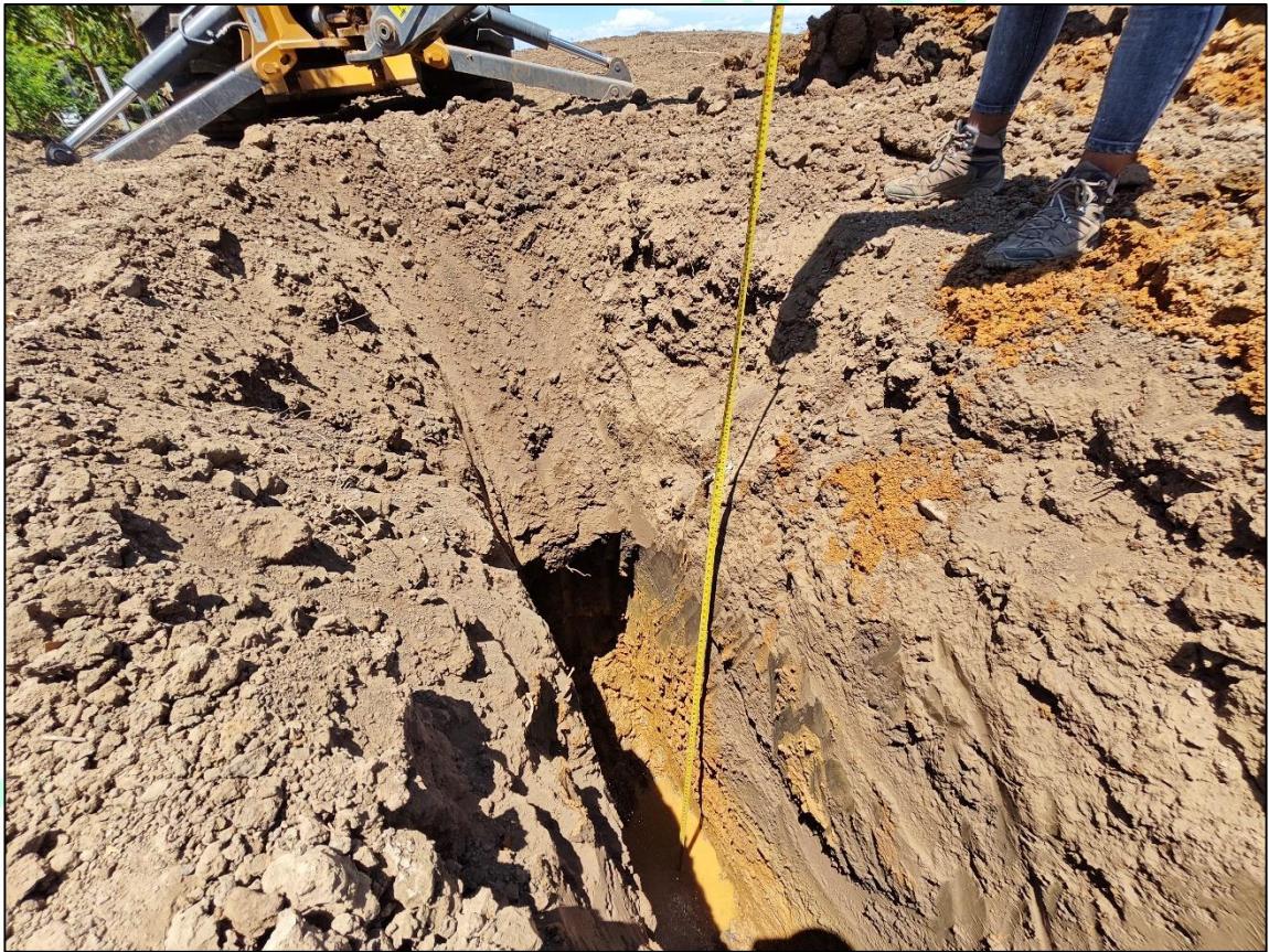
Imagen 11. Apique 3 terminado y medición de perfil estratigráfico.
