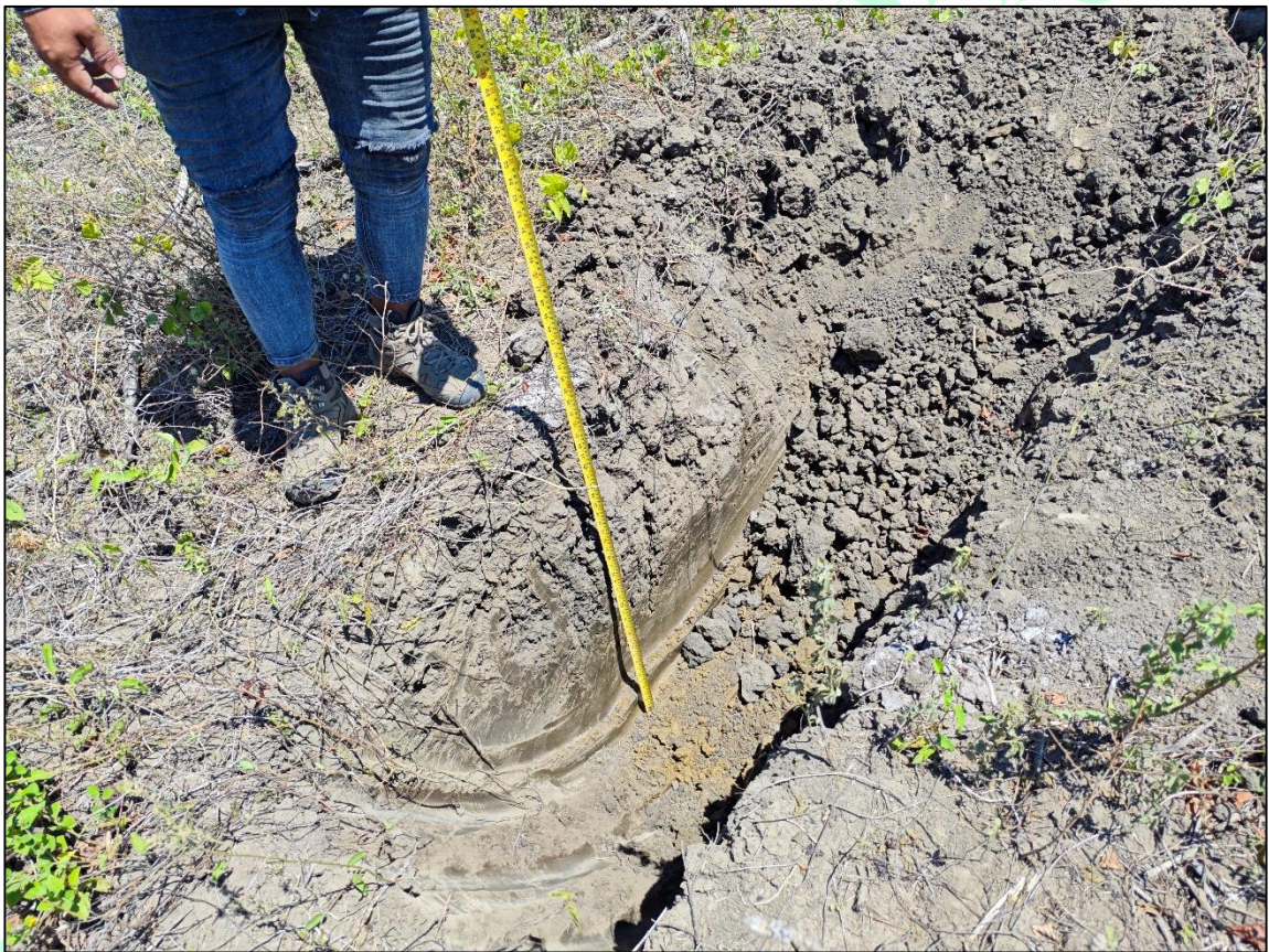
Imagen 18. Apique 10 terminado y medición de perfil estratigráfico.
