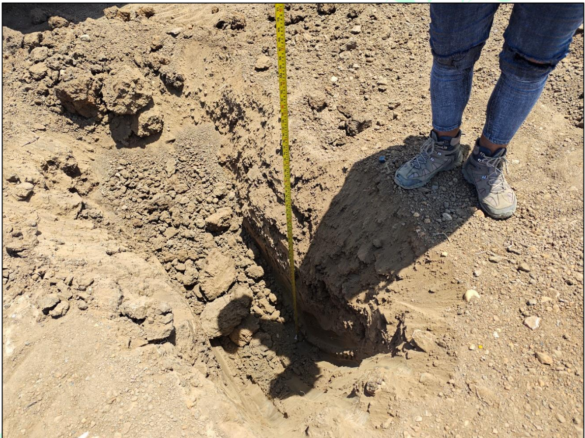
Imagen 13. Apique 5 terminado y medición de perfil estratigráfico.
