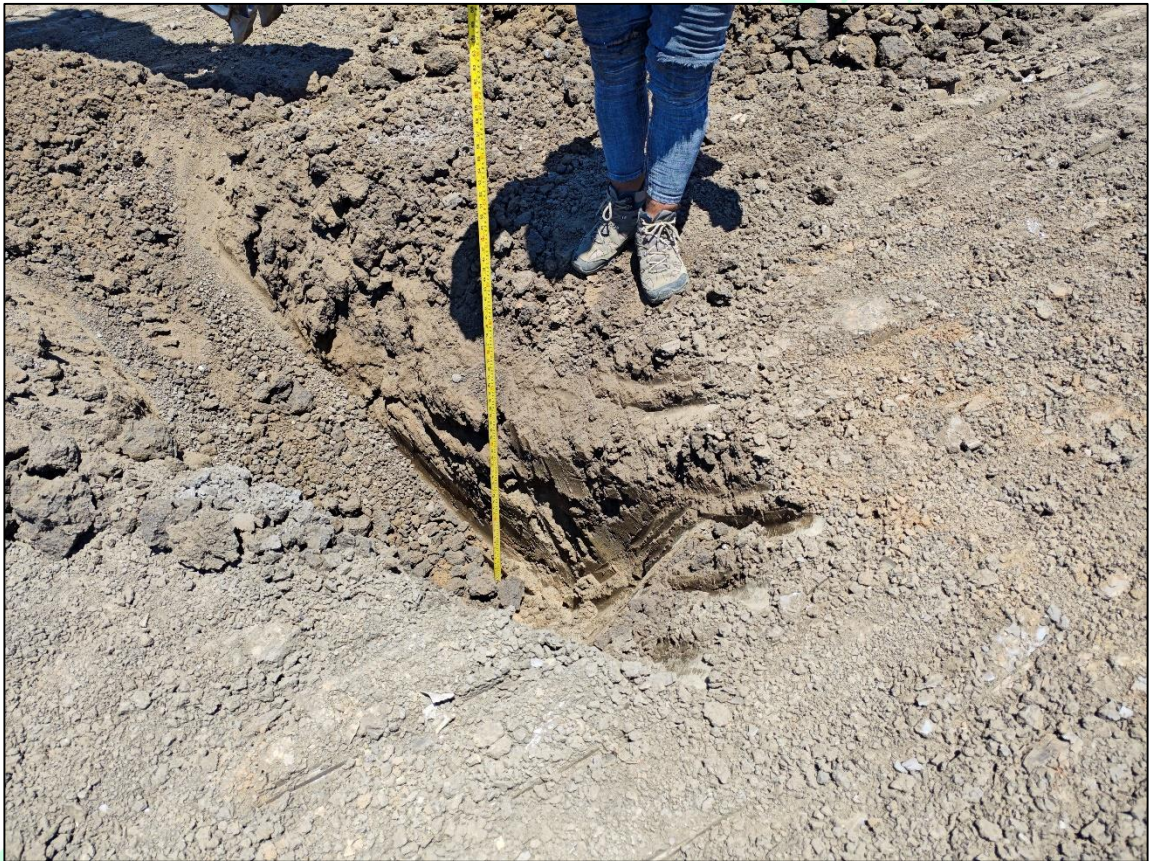
Imagen 17. Exploración Apique 9 terminada y medición de perfil estratigráfico.
