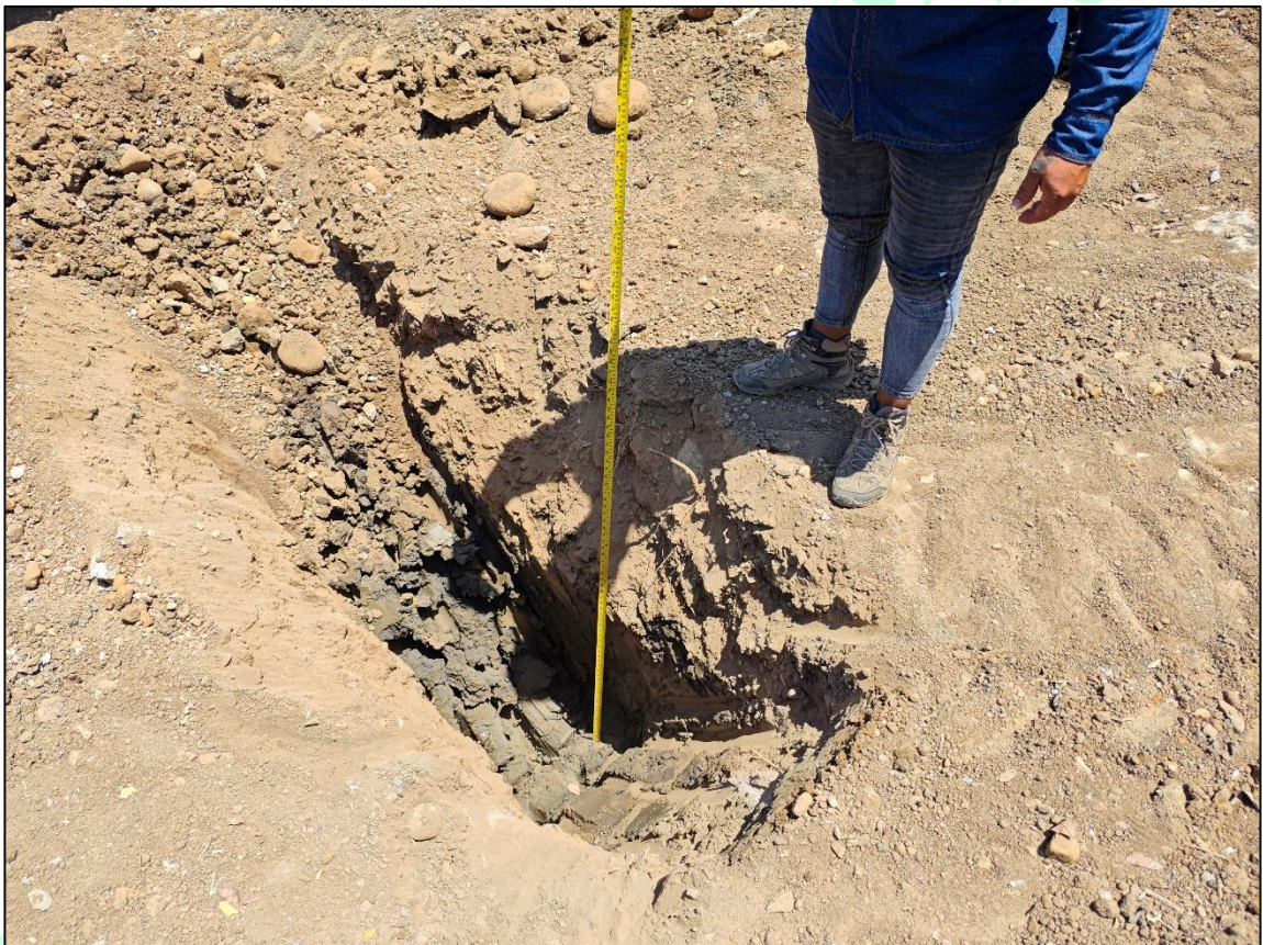
Imagen 12. Exploración Apique 4 terminada y medición de perfil estratigráfico.
