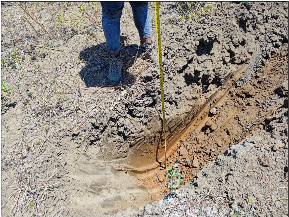
Imagen 16. Apique 8 terminado y medición de perfil estratigráfico.
