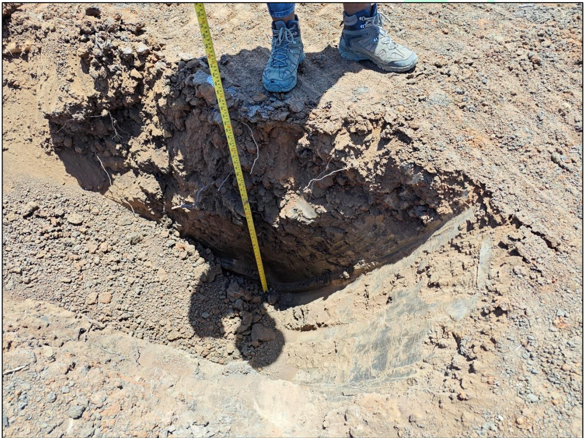
Imagen 14. Apique 6 terminado y medición de perfil estratigráfico.
