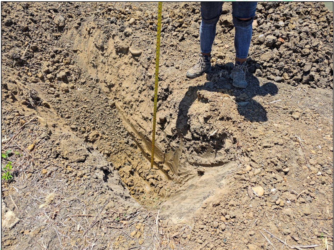
Imagen 15. Apique 7 terminado y medición de perfil estratigráfico.
